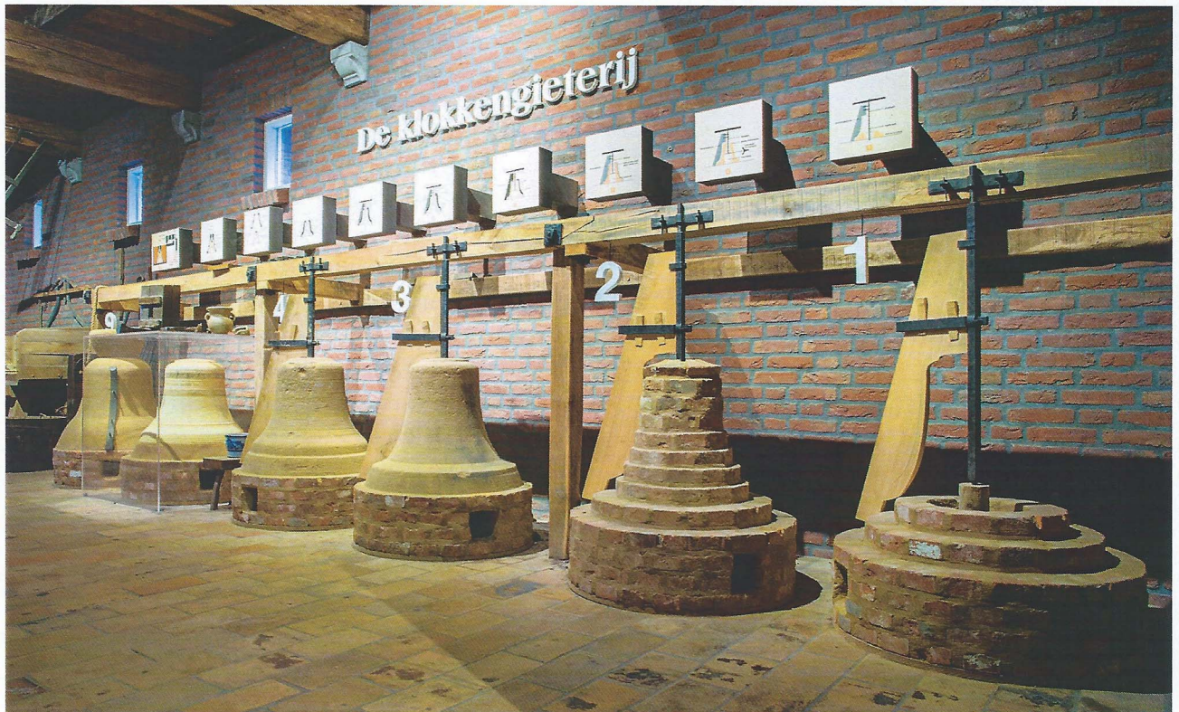
Afb. 6 Opeenvolgende opbouwstadia vóór het gieten
