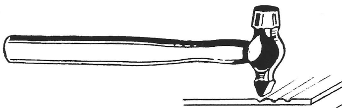
het rekken van een metalen plaatje
