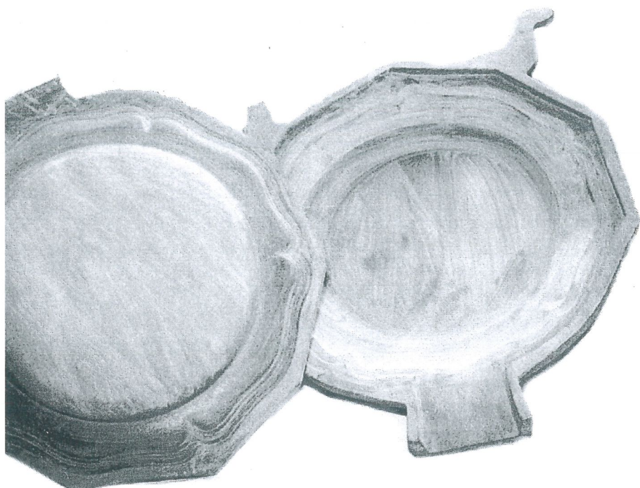
Fig. 4. Carl Wessmans gjutjärnsform daterad 1757/1767 för ett fempassigt fat, nr. 2 i tabellen. Liksom nr. 1 har även denna form de onödiga snibbarna i formens underdel, som medförde extraarbete efter gjutningen eftersom tallrikarna/faten inte kunde svarvas ut till kant. Det är möjligt att både Åberg och Wessman använde tallrikar och fat tillverkade av mästarna i Frankfurt am Main som förlaga (mall/modell) vid formtillverkningen, som skedde i sandflaska. Både före och efter tillkomsten av dessa ämbetsformar tillverkade stockholmsmästarna sina rokokotallrikar/fat med utgångspunkt från vanliga runda tallrikar/fat, som klipptes och formades innan bården applicerades och som därför oundvikligen hade rokokosnibben även på undersidan. Kanske dessa blev gjutmodeller?
