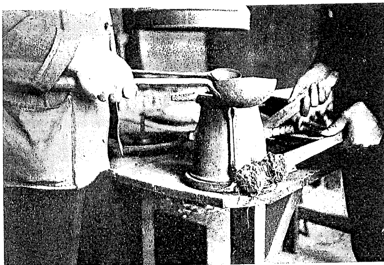
Bild 14. Gjutning av stommen till ett revstop. Santessons tenngjuteri, Stockholm. Nord. mus. foto 1919.
