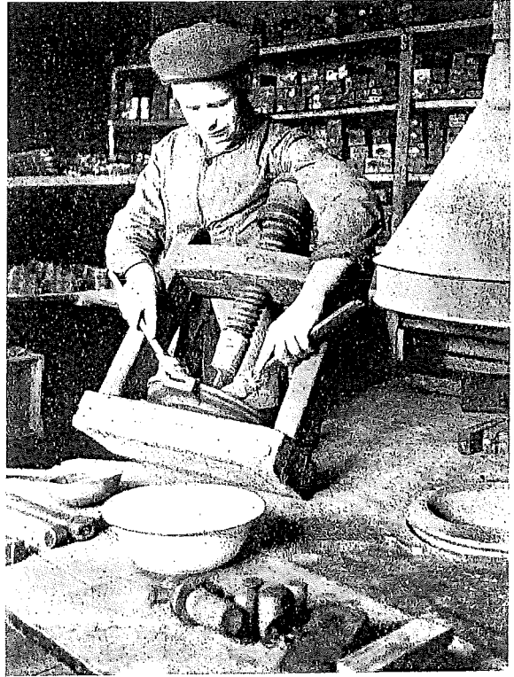
Bild 12. Gjutning av tallrik: avkylning av gjutformen. Santesons tenngjuteri, Stockholm. Nord. mus. foto 1919.
