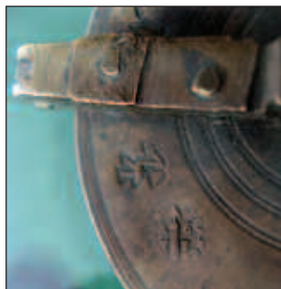
Afb. 1b/c Het Franse ijkmerk op het deksel van het sluitgewicht.
