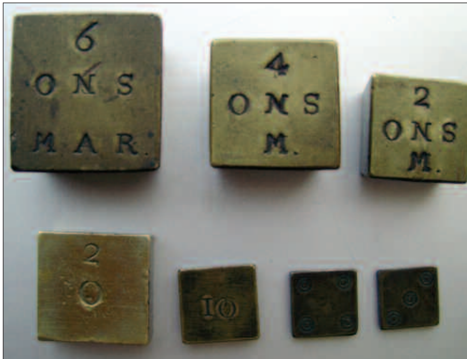
Afb. 3a Zeven tapse vierkante gewichten voor fijne weging uit Brussel, gemaakt door Delmotte.
