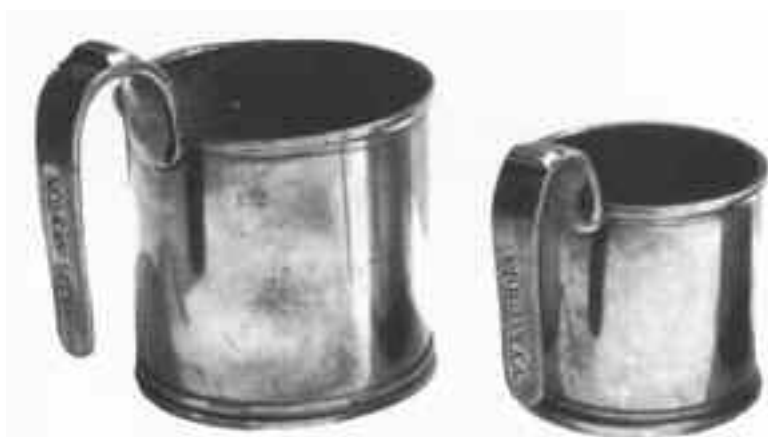
Afb. 5 Tinnen melkmaten van NED. HALVE KAN en NED. KAN LITRE, met laag, open oor. Tinnegieter H. Krabbe en Zn., Den Haag. Dit zijn modellen, uitgeleend aan de ijkkantoren. Particulier bezit. Foto overgenomen uit 'Nederlandse metrische inhoudsmaten', G.M.M. Houben, 1988.
