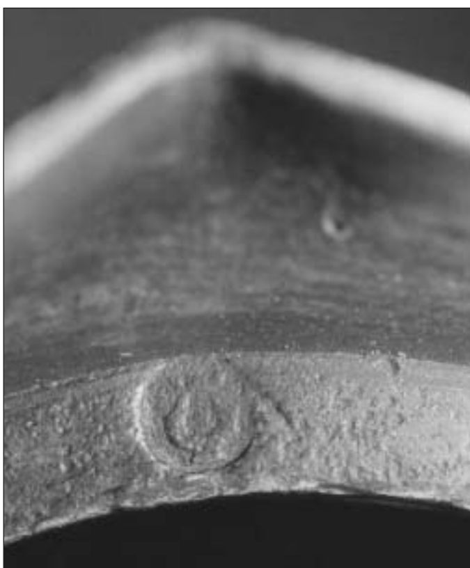
Afb. 5 Merk van arrondissementsijker H.J. Wennekers te Zutphen, binnen op de meetrand van NED:KAN(LITRE).
