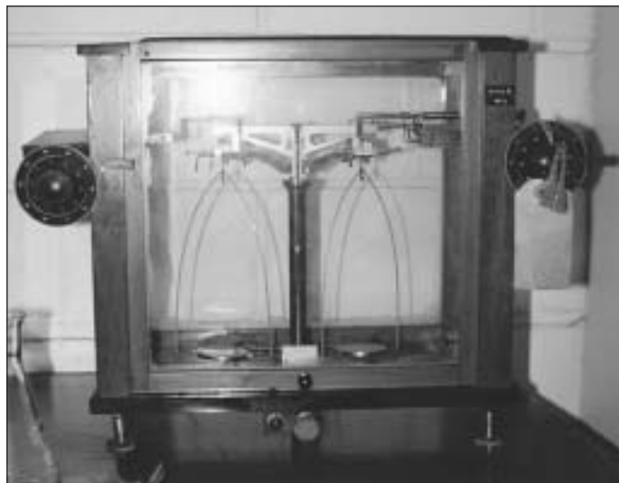
Afb. 19 Kleine Julian H. Becker balans (weegvermogen 100 g) met bijschakelgewichten aan beide zijden van het juk.
