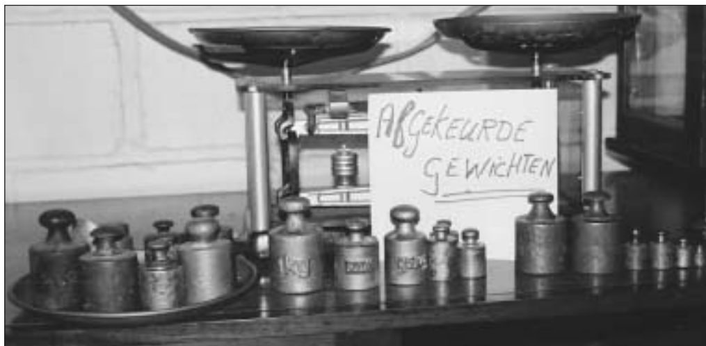
Afb. 11 Afgekeurde gewichten, met op de achtergrond een Amerikaanse winkelweegschaal (torsiebalans).
