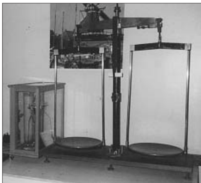
Afb. 20 In de ijkkamer rechts een Julian H. Becker balans, weegvermogen 50 kg, ca. 1935; links een kleine Sauter balans, ca. 1961.
