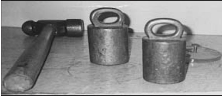
Afb. 13 Kijkje in de kast van het ijkkan- toor: twee Nederlandse messing krukge- wichten van 2 kilogram, een afdekglas voor een tinnen maat en een ijkhamer.
