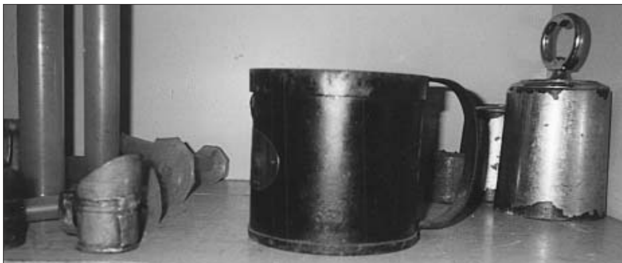
Afb. 16 Kijkje in de kast van het ijk-kantoor: Nederlandse geklonken ijzeren maat van 2 liter met opmerkelijk handvat. Verder: twee Nederlandse ijzeren standaardgewichten, een blikken maatje (modern Surinaams fabrikaat) en inhoudsmaten van kunststof.
