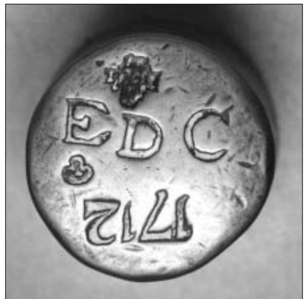
Afb. 6 Bovenzijde van een blokgewicht van een half pond, geijkt door Jan Lemmerman in Amsterdam, 1712. Herkeurd in Hoorn, 1789–1797 en op de zijkant verder tot en met 1819.
