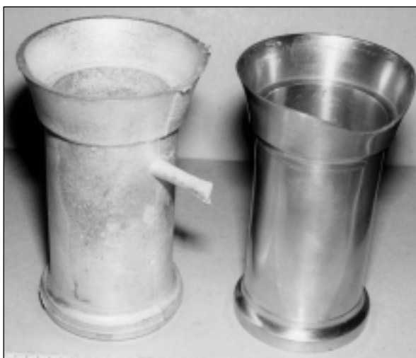
Afb. 11 Links een onbewerkte 2 deciliter. Rechts eenzelfde maat, fijn afgedraaid en met geknipte schenkrand, wachtend op een handvat.
