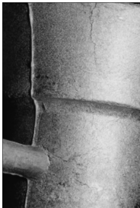
Afb. 8 Krimpseuren in de schenkrand en rond de gietloop, te wijten aan een te hete gietvorm.
