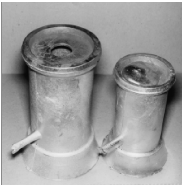
Afb. 10 Rechts: een halffabrikaat tinnen maat van 1 deciliter, waarbij het gat in de bodem overdadig gevuld is met tin. De bobbel wordt later weer afgedraaid. Links een 2 deciliter die deze bewerking nog moet ondergaan.
