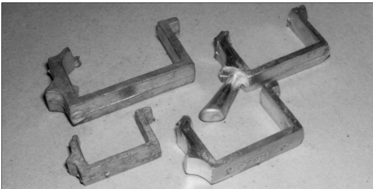
Afb. 13 Handvatten van tinnen maten van ½ Liter, 2 en 1 deciliter, in verschillende produktiestadia.
