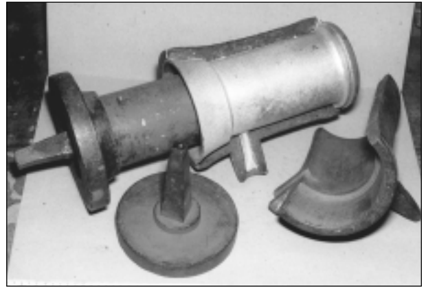
Afb. 9 Het lossen van het gietstuk uit de gietvorm; hier een tinnen maat van 2 deciliter.
