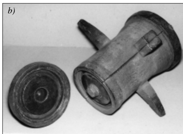
Afb. 7 Gietvorm voor een tinnen maat van 2 deciliter. a) in vier delen; b) bijna gesloten; het deksel voor de bodem moet nog worden aangebracht, zichtbaar is de uitstulping die een gat in de bodem zal achterlaten; c) compleet in elkaar gezette gietvorm, middenboven is de gietloop zichtbaar.
