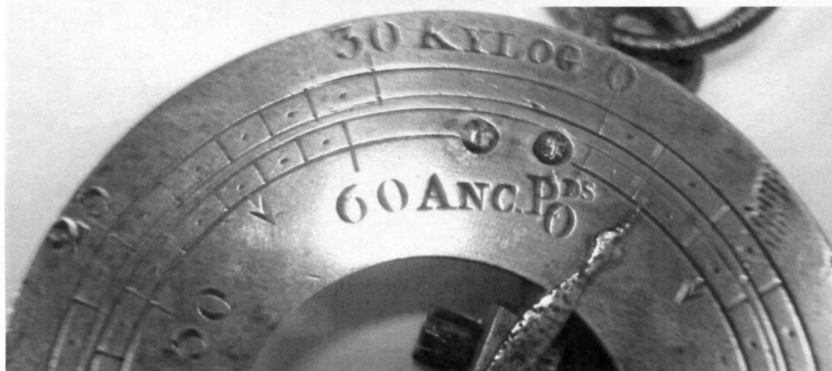
Numéro 4, marqué Hanin : hauteur : 18 cm ; diamètre du cadran : 8 cm ; portées de 30 kylog et 60 (livres) ancien poids ; 1 point par \frac{1}{2} kg et par livre, 1 trait par kg et 2 livres ; chiffré par 5 kg et 10 livres avec flèche intermédiaire pour 5 livres.
