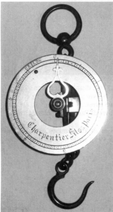
Numéro 6, sans marque : portée de 100 kg, 1 point par 1/2 kg, 1 trait par kg. Chiffré par 5 et 10 kg.
