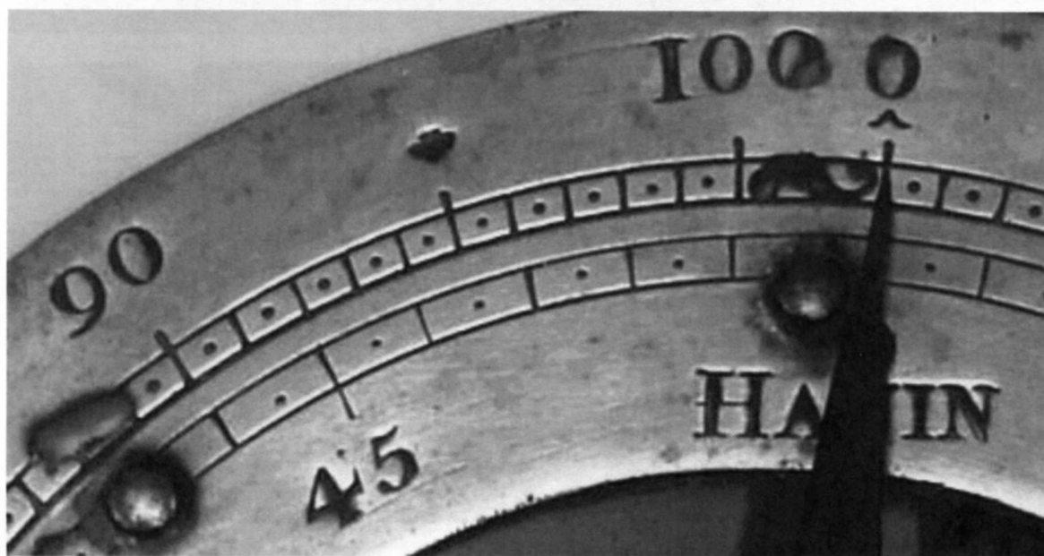
Numéro 3, marqué Hanin : hauteur : 25 cm ; diamètre du cadran : 12,5 cm ; portées de 100 (livres) et de 49 (kilogrammes) mais sans indication d'unité ; 1 point par \frac{1}{2} kg et par livre, 1 trait par kg et 2 livres ; chiffré par 10 livres et 5 kg avec une flèche pour 5 livres.
