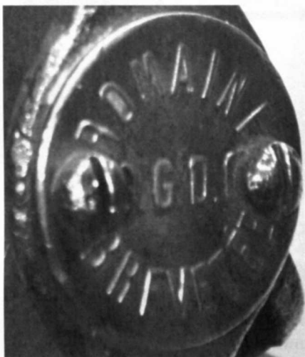
Ci-dessus : modèle presque identique avec la même plaque portant l'indication « ROMAINE BREVETEE S.G.D.G » mais avec le petit côté gradué de 0 à 15 kilogrammes, le grand côté de 15 à 30 kilogrammes, par 100 grammes.
