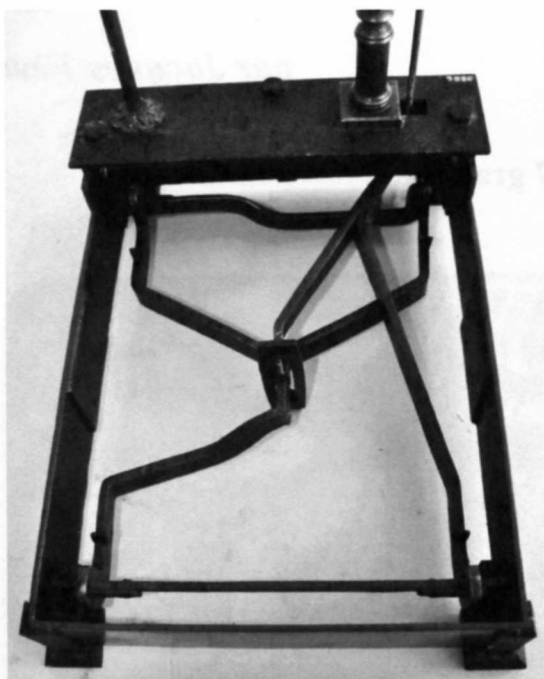
Ci-dessus : liaison directe entre couteaux des leviers et coussinets du tablier (modèles 1 et 3) Ci-dessous : liaison par brides à palonnier et fourches sous le tablier (modèle 2)
