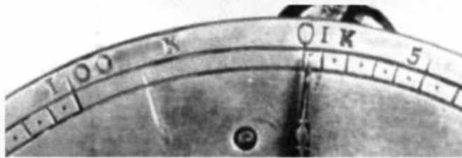
Numéro 6, sans marque : portée de 100 kg, 1 point par 1/2 kg, 1 trait par kg. Chiffré par 5 et 10 kg.
