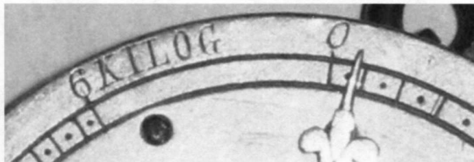
Numéro 6, sans marque : portée de 100 kg, 1 point par 1/2 kg, 1 trait par kg. Chiffré par 5 et 10 kg.
