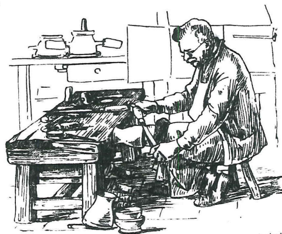
Petit banc du potier d'étain. Il l'utilise assis sur un trépid bas li hame . Liège, XIX e s. — Long. 1 m. 20, Haut. 45 cm. Provient de l'atelier Houtain. Collections du Musée, N° A. 17317/C. 2467
