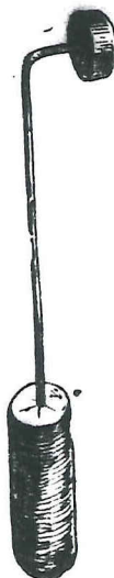
Li disbouyeleû , outil servant à redresser les bosses. Provient de l'atelier Houtain. Liège, XIX e s. — Long. 265 mm. Coll. du M., N° A. 17314/C. 2446
