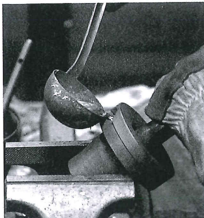
Tin wordt in een ijzeren mal gegoten
